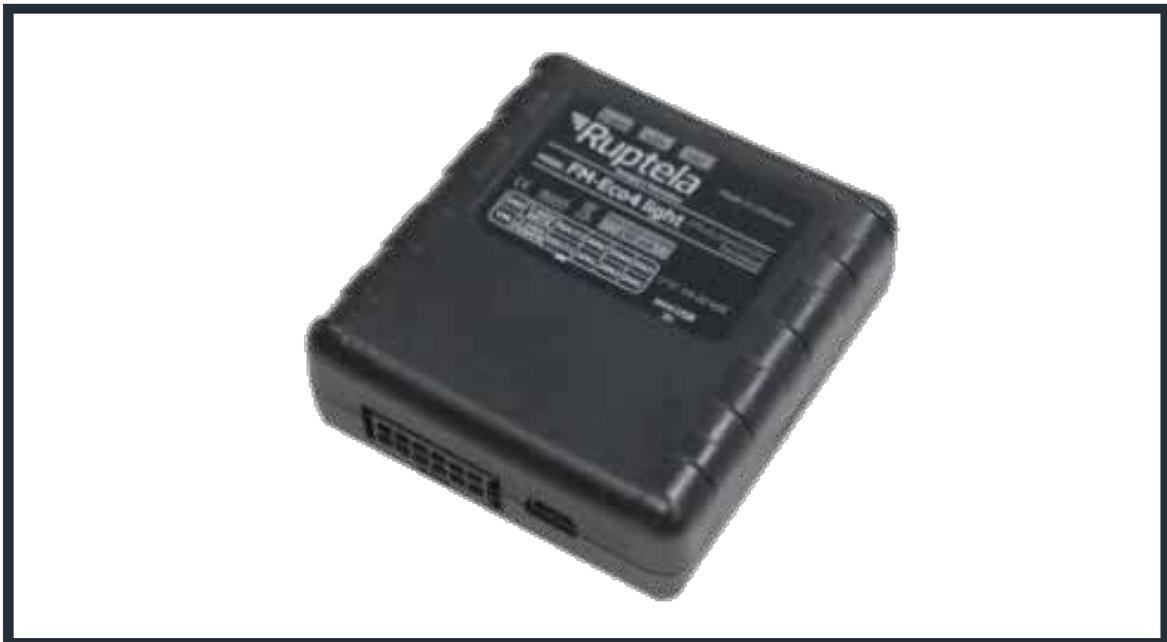
Este dispositivo GPS cuenta con las entradas necesarias para conectar hasta 4 sensores simultáneos: sensor de puerta, botón de pánico, detección de ignición, entre otros. Dentro de sus características tienes la opción de enlazar un ID Button (botón de identificación de conductor), además soporta hasta 2 sensores de combustible análogos.
